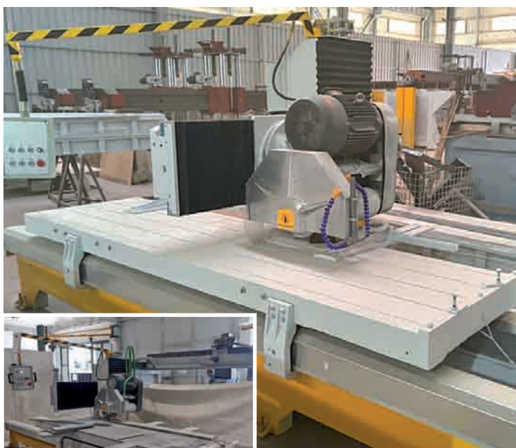
FRESA A BANDIERA SEMIAUTOMATICA MOD.(F) SYQ-600-CE
